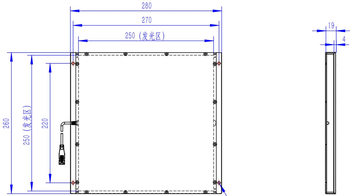
4- $\varnothing$ 5通孔 (安装孔)
